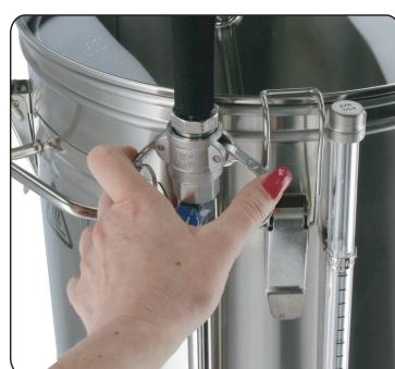
Zum Verriegeln ziehen Sie den Cam-Lock-Hebel nach unten
