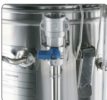
Zirkulationsrohr in den Cam-Lock-Anschluss einführen
